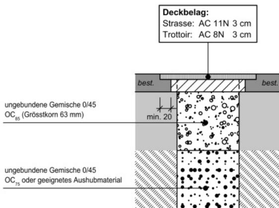
Abfräsen Tragschicht 30 mm und min. 20 cm über Grabenflick. Seitliche Ränder mit Verbundmasse (z.B. Risoplast) voranstreichen oder Einbau eines bituminösen Fugenbandes.
